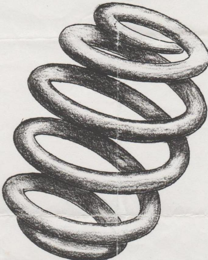
Le ressort hélicoïdal de type tonneau est une technique automobile relativement récente.
